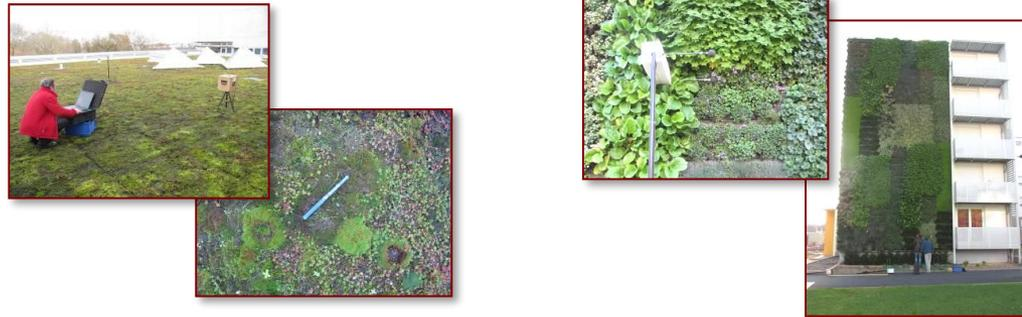
Mesures *in-situ* des propriétés d'absorption acoustique (impédance) des surfaces végétalisées (toits et façades)
