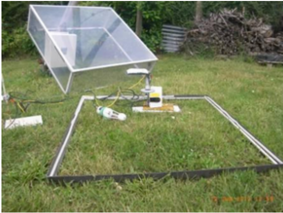
Dispositif de mesure – Chambre à transpiration (CEREMA Team)
